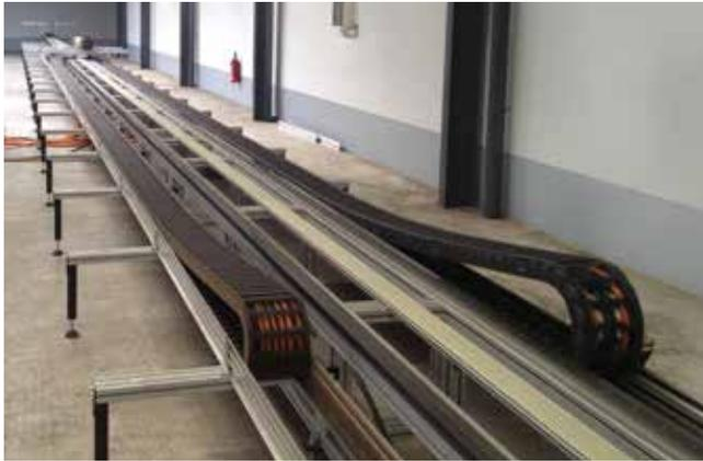
Instalação de teste em esteira porta-cabos de 40 m
