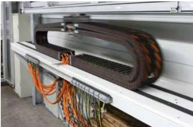
Instalação de teste em esteira porta-cabos de 3 m
