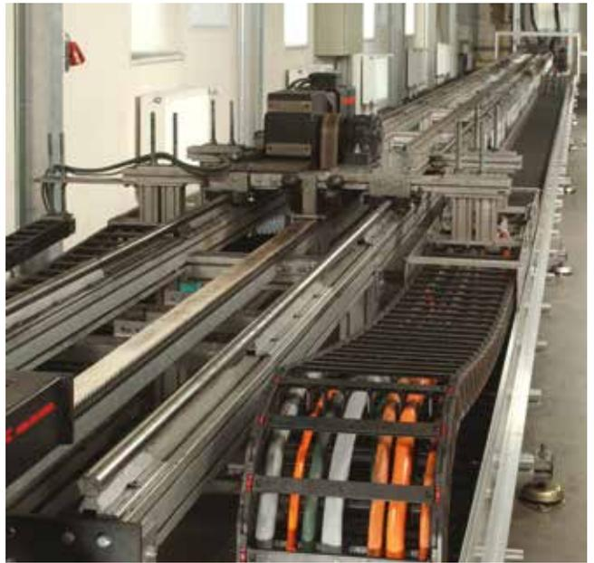
Instalação de teste em esteira porta-cabos de 18 m
