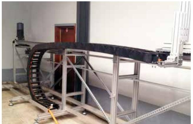
Instalação de teste em esteira porta-cabos de 6 m para seções transversais maiores
